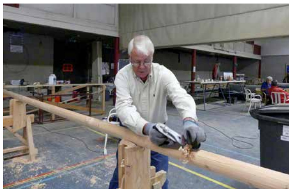
De ra (dwarshout van de mast) wordt zorgvuldig afge- werkt. Foto Norma Mulder
